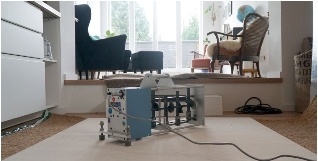
Bei Bedarf können Trittschallmessungen per Hammerschlagwerk von Unifloor auf der Baustelle durchgeführt werden.
